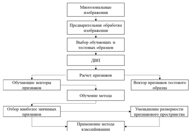
Рисунок 1 - Блок-схема предложенного метода интерпретации космических снимков
