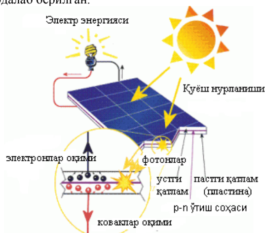
1-расм. Куёш элементининг ишлаш тамойили Маълумки, 1\text{ м}^2 юзага (ер шароитида) куёшдан ўртача 1370\text{ Ж} энергия тушиши аниқланган. Бундан кўринадики, куёш энергияси энергетик жиҳатдан
