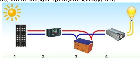
3-расм. Куёш энергиясини электр энергияга айлантиришнинг технологияси
