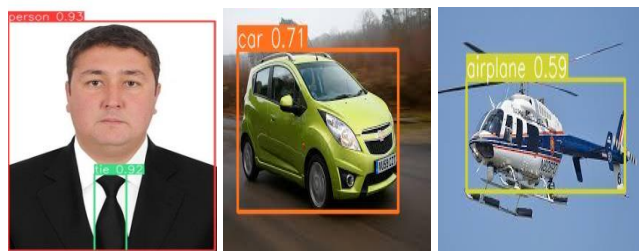
1-rasm YOLO algoritmda tasvirlarni turini aniqlash.
