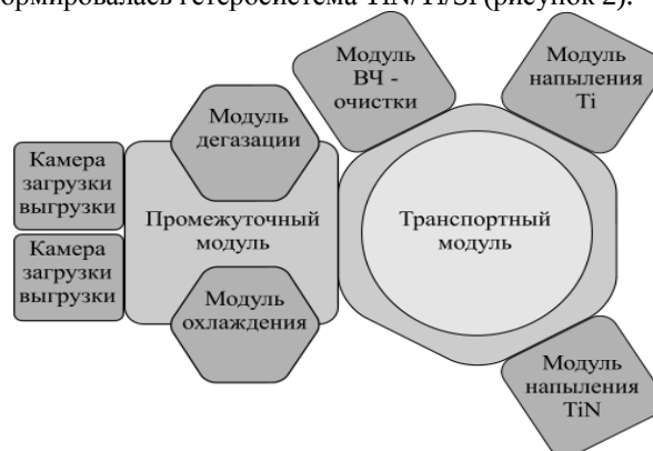
Рисунок 2- Схема установок напыления Varian m2i и Endura
