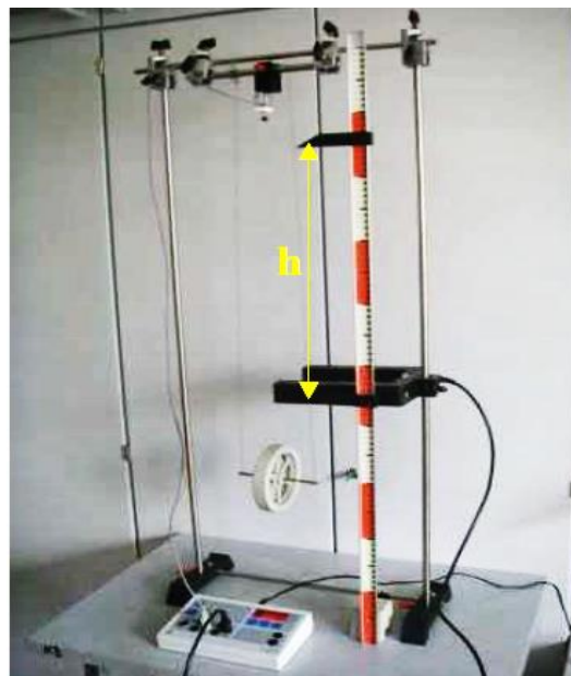
1-rasm. Maksvell diskilari yordamida energiya saqlanish qonunini tekshirish uchun mo'ljallangan tajriba qurilmasi.
