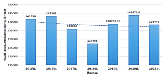
4-расм. ҚФЭСда 2015-2021 йиллар оралиғида ишлаб чиқарилган электр энергия W(\text{кВт}\cdot\text{соат}) диаграммаси ва даражаланган тренд чизиги
