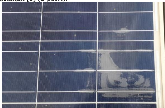
2-расм. HANHWA (HSL250) компаниясининг нуқсонли қуёш панели.
