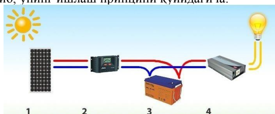
3-расм. Куёш энергиясини электр энергияга айлантиришнинг технологияси
